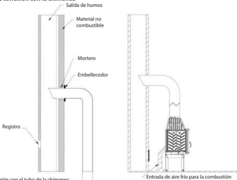
Diámetro de unión con el tubo de la chimenea
