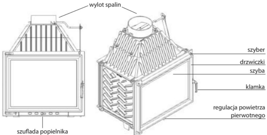
Przed pierwszym rozpaleniem należy usunąć wszystkie naklejki lub części wyposażenia, znajdujące się w popielniku lub palenisku. Podczas pierwszego palenia w piecu należy utrzymywać minimalną temperaturę oraz nieco uchylić drzwiczki (ok. 1-2 cm), aby materiał uszczelniający połączył się z lakierem. Wszystkie materiały muszą powoli przystosować się do wysokiej temperatury.
