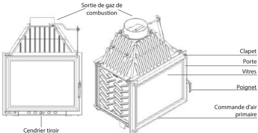
Avant d'allumer le feu pour la première fois, il est nécessaire d'enlever toutes les étiquettes ou les raccords du cendrier ou du foyer. Lorsque le feu est allumé pour la première fois, une température minimale doit être maintenue, avec la porte entrouverte (environ 1 à 2 cm), de sorte que le matériau d'étanchéité peut fusionner avec le vernis. Tous les matériaux doivent lentement s'adapter aux hautes températures.
